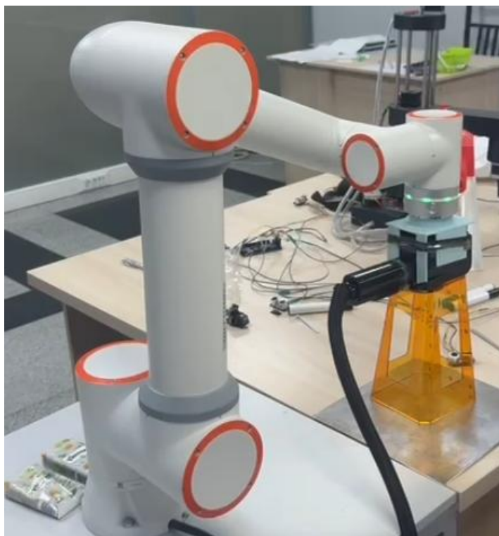
Рисунок 43 – Демонстрация процесса нанесения лазера на металлический образец (полный вид)
