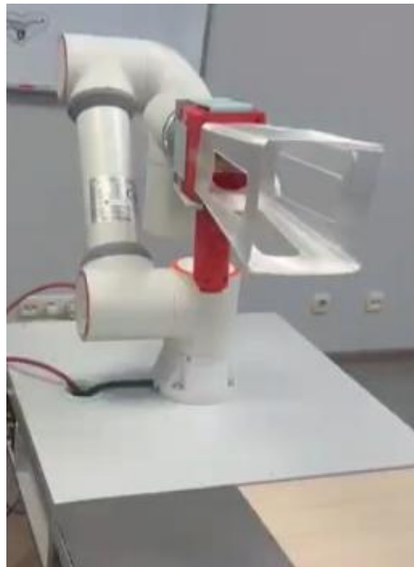
Рисунок 40 – Демонстрация ERA Cobot M5 с 3D-макетом лазерного аппарата
