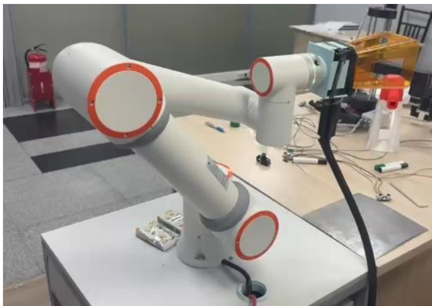
Рисунок 41 – Демонстрация ERA Cobot M5 с установленным лазерным аппаратом
