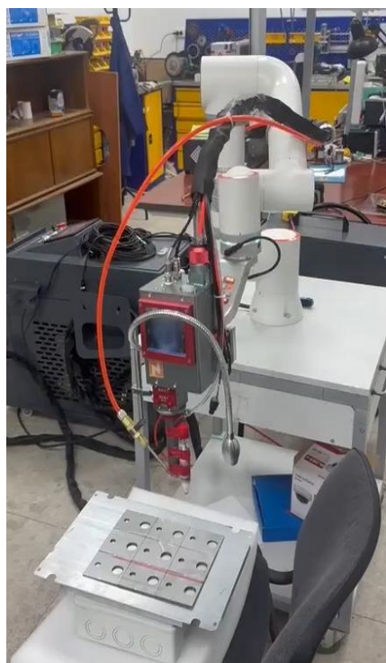
Рисунок 44 – Демонстрация движения робота с установленным сварочным аппаратом по заданной траектории и результат сварочной траектории
