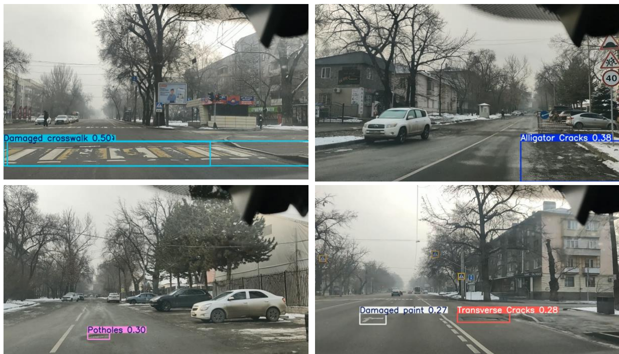
Рисунок 26 – Кадры работы системы мониторинга в режиме реального времени при сложных условиях освещения и динамическом фоне
