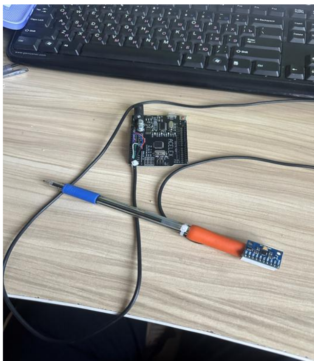
Рисунок 2.4 – Лабораторный прототип сенсорного устройства Smart Pen
