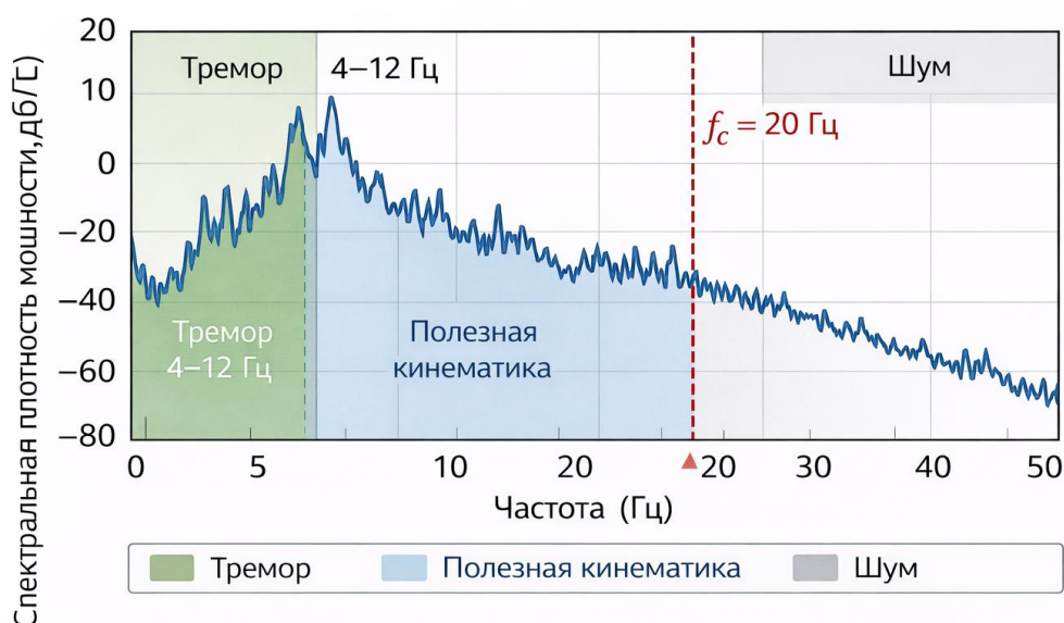
Рисунок 3.2 – Частотный спектр кинематического сигнала письма
