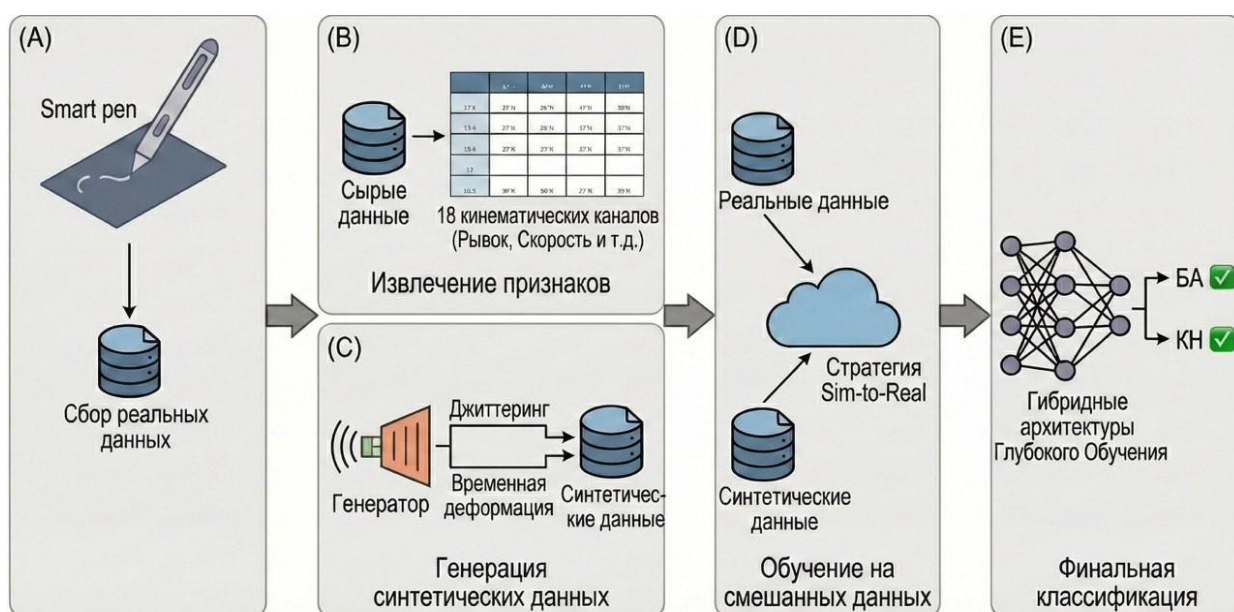
Рисунок 3.1 – Архитектура предварительной обработки, аугментации и формирования обучающих наборов данных
