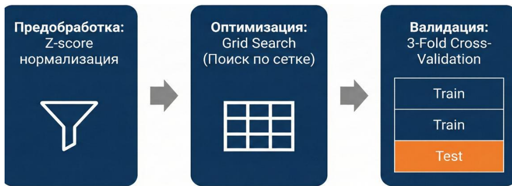
Рисунок 4.1 – Схема процедуры предобработки данных, оптимизации гиперпараметров и 3-кратной перекрестной проверки
