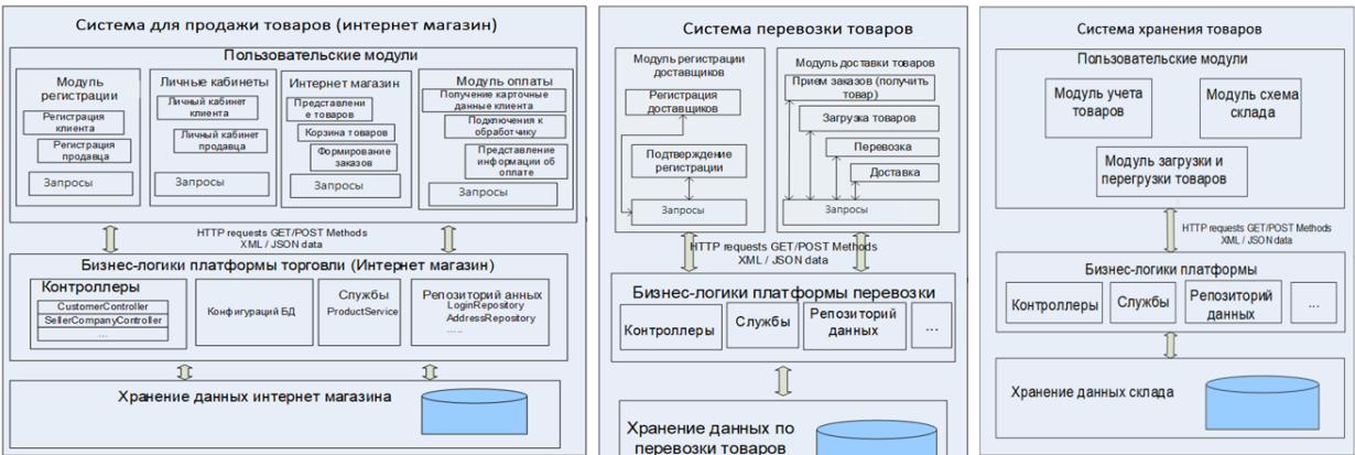
Рисунок 3 - Программная архитектура интегрированной платформы логистики
