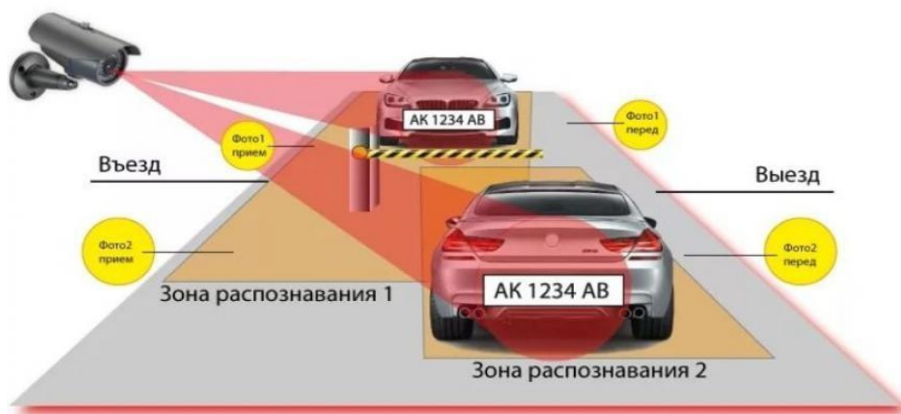
Рисунок 1.5 – Принцип распознавания автомобильных номеров
