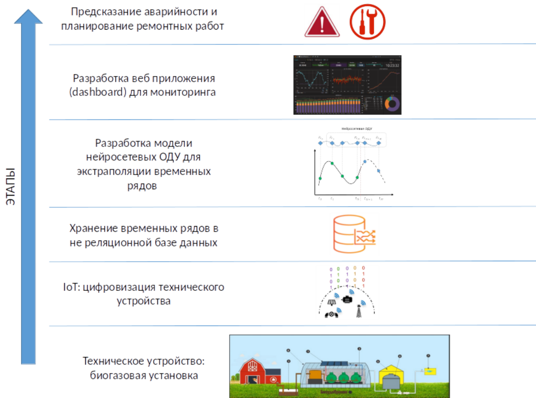
Рисунок 4.15 - Схема потока данных и задачи, решаемые в проекте.
