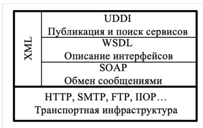
Рисунок 3.3 - Взаимодействие протоколов UDDI, WSDL, SOAP, HTTP при использовании веб-сервисов
